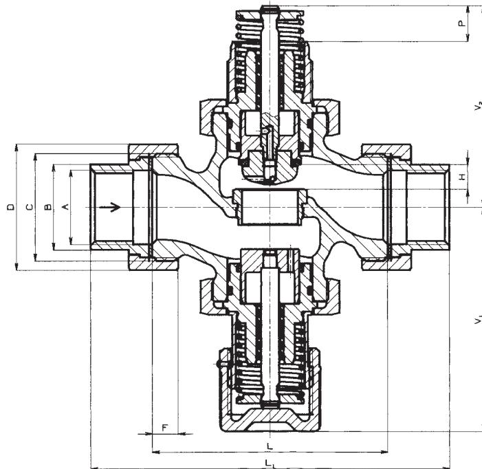
Вентили RV 122 P..W с приварным резьбовым соединением
