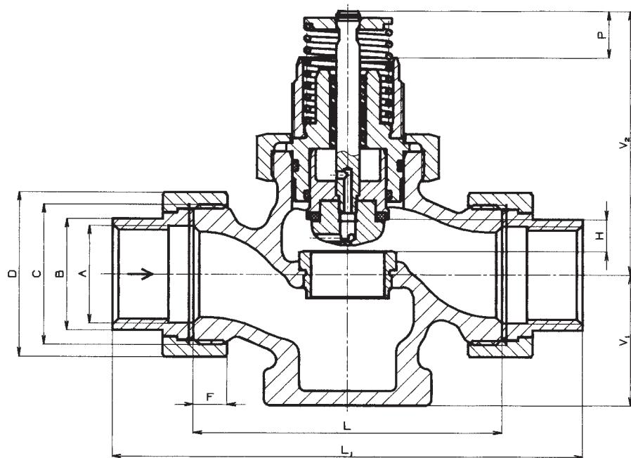
Вентили RV 122/W с приварным резьбовым соединением
